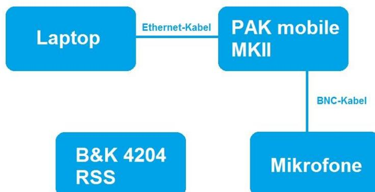
Abb. 31 – Messaufbau mit Referenzschallquelle
