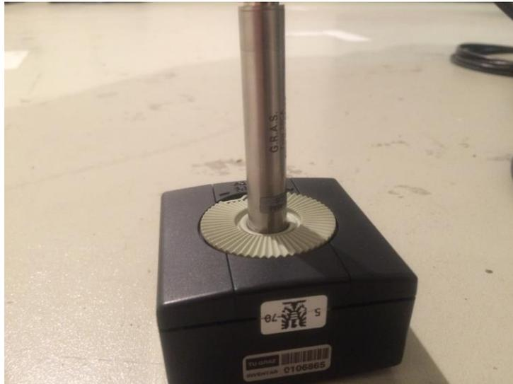
Abb. 10 – Kalibrierung des Messmikrofones
