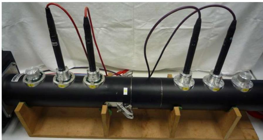
Abb. 42 – Impedanzrohr mit engem Mikrofonabstand
