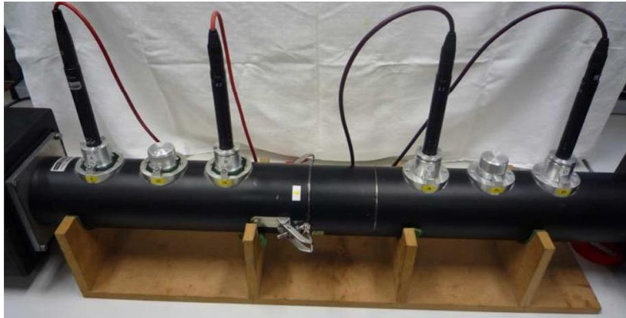
Abb. 43 – Impedanzrohr mit weitem Mikrofonabstand
