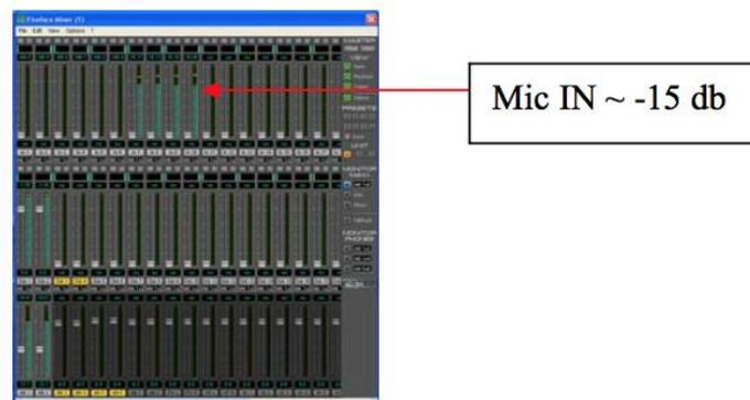
Abb. 47 – Einpegeln des Eingangssignals
