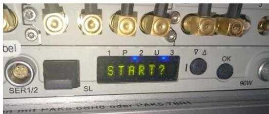
Durch mehrmaliges Drücken des Startknopfes erscheint am Display der Eintrag „START?“. Über den „OK“-Button wird das Gerät gestartet.
