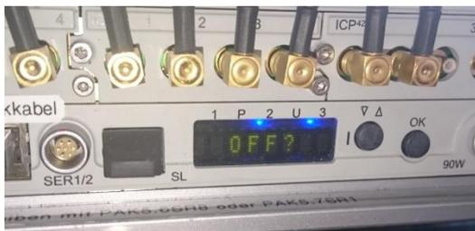
Nach vollendeter Messung wird das MKII auf dieselbe Weise ausgeschaltet. Nach mehrmaligem Drücken des Startknopfes, erscheint der Eintrag „OFF?“. Über den „OK“-Button wird der Ausschaltvorgang bestätigt.
