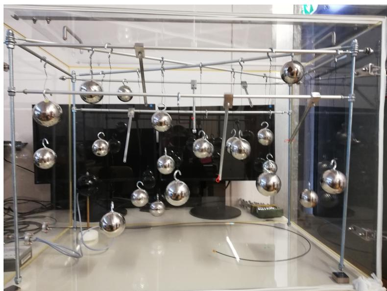
Abbildung 5.1: Der 1:10 Hallraum mit Kugeldiffusoren und Ultraschalllautsprecher
