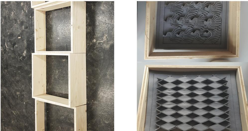
Abbildung 4.8: Leere und mit Absorbern bestückte Rahmen
