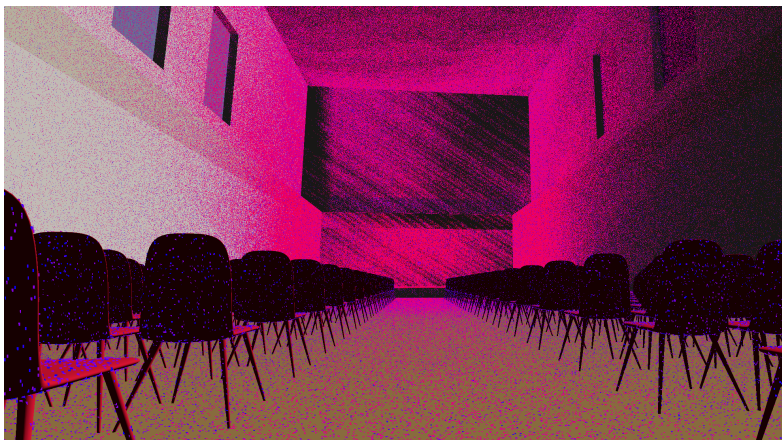
Abbildung 2.7: Grafische Darstellung der Soundmap in einem fiktiven Konzertsaal. Die Positionen der sichtbaren Punkte entsprechen \vec{p}_i^\xi . Die Farbgebung wird zwischen 1 (rot) und 0 (blau) linear interpoliert und ist vom Parameter R_i^\xi(B) abhängig.
