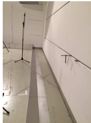
(d) Foto und Skizze der Anordnung 'L-Form niedrig', h = 35 cm, d = 70 cm
