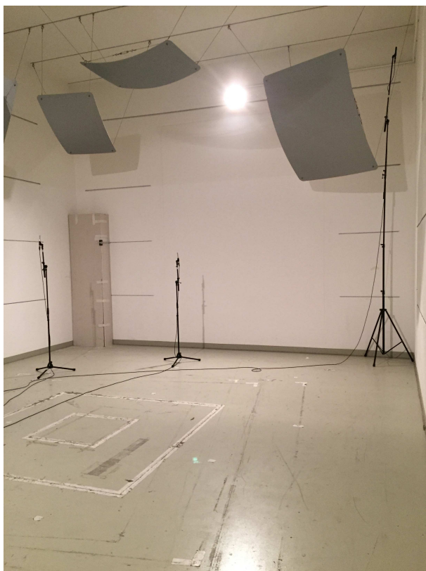
(a) Foto des Hallraumes im leeren Zustand
