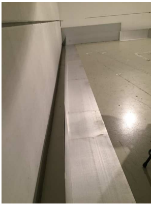
(a) Foto und Skizze der Anordnung 'L-Form niedrig', h = 35 cm, d = 17.5 cm
