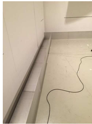
(b) Foto und Skizze der Anordnung 'L-Form niedrig', h = 35 cm, d = 35 cm
