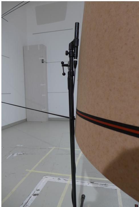
Abbildung 3.4: Nähe des Mikrofons zur Platte bei einigen Messpositionen, hier MP 43
