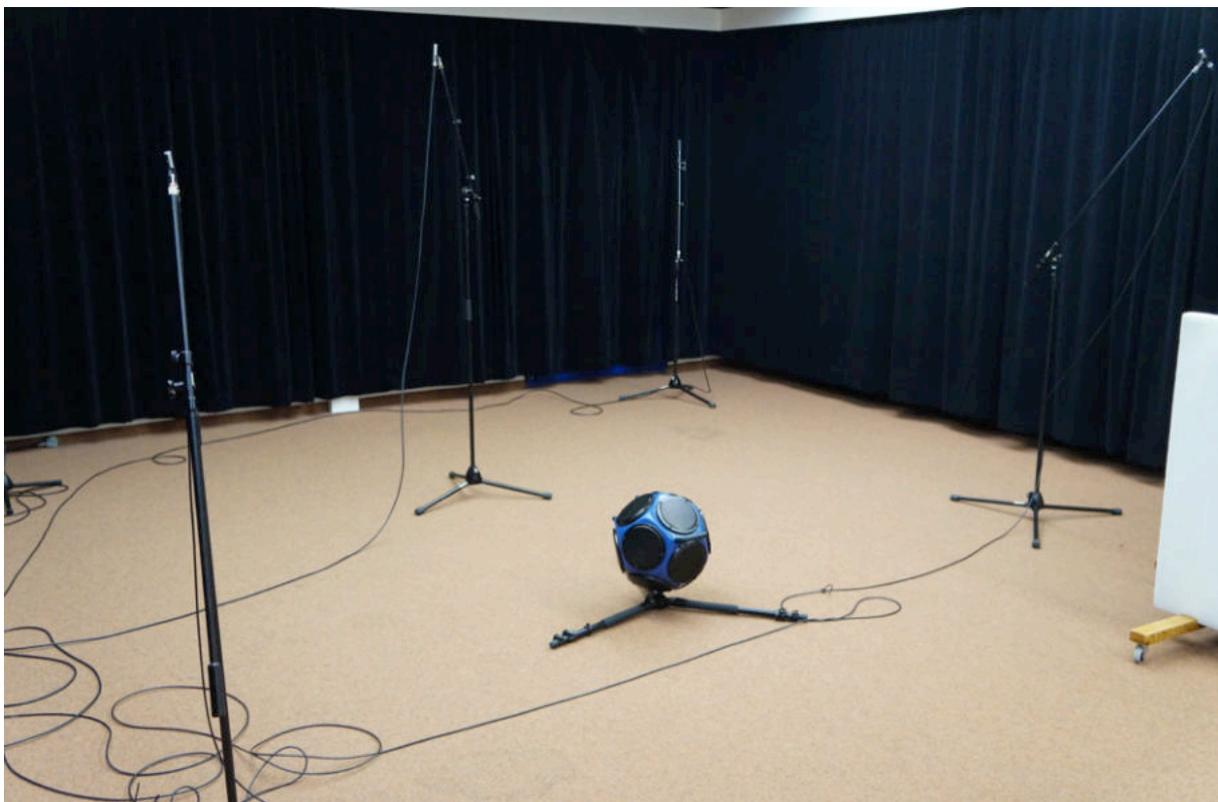
*Abb. 30: Mikrofon- und Lautsprecherplatzierung (Dodekaeder)*
