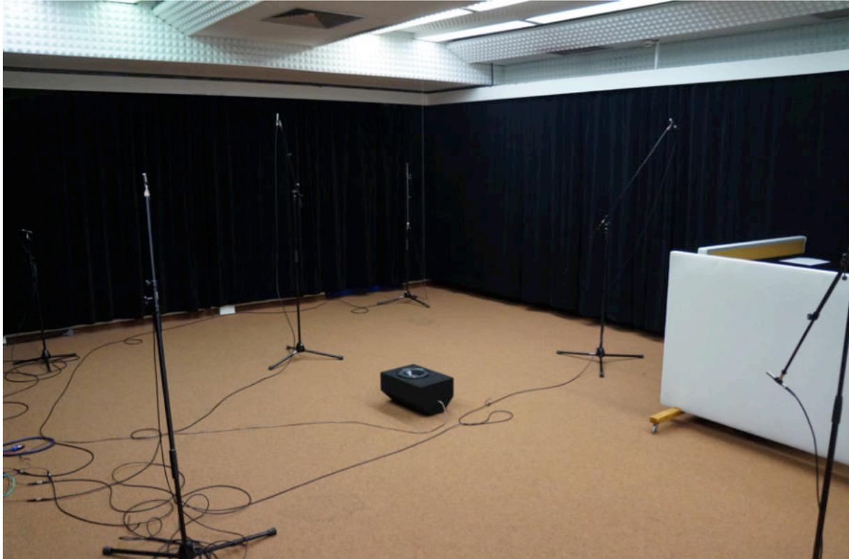
*Abb. 29: Mikrofon- und Lautsprecherplatzierung im Tonstudio*
