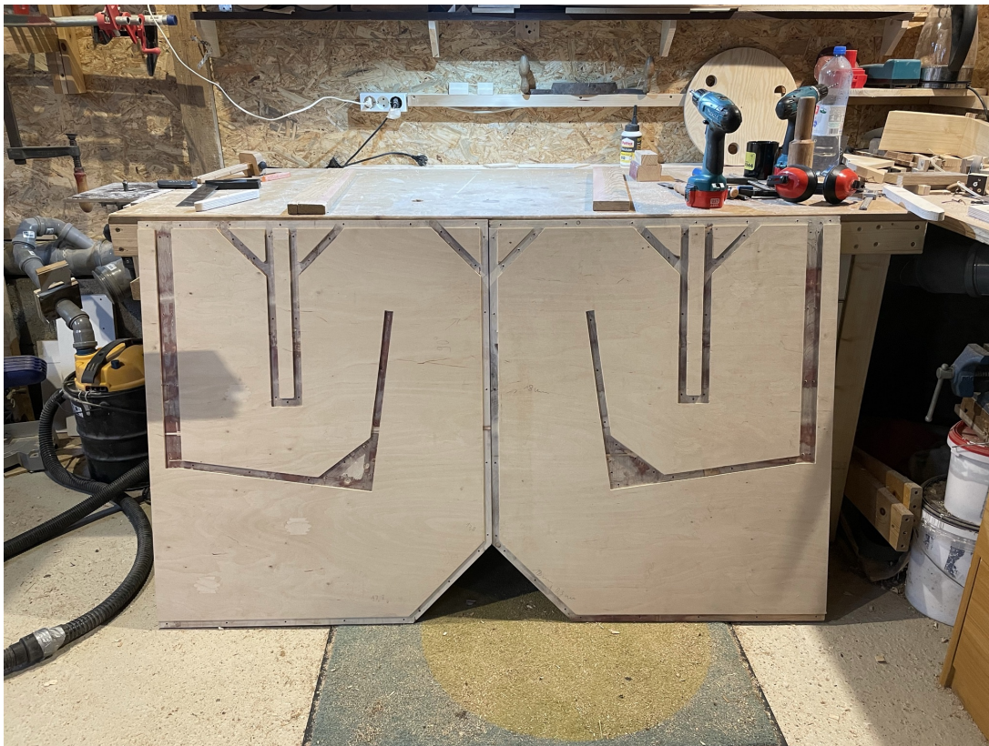
Abbildung 3.3: Gefräste Wände des Lautsprechers
