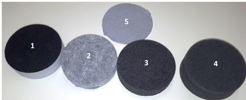
*Abbildung 3.8: Vermessende Materialien. 1 – Melaminharzschaum mit Filz; 2 – Hartfilz; 3 – Schaumstoff hart; 4 – Schaumstoff weich; 5 – Dünne Filzschicht*
