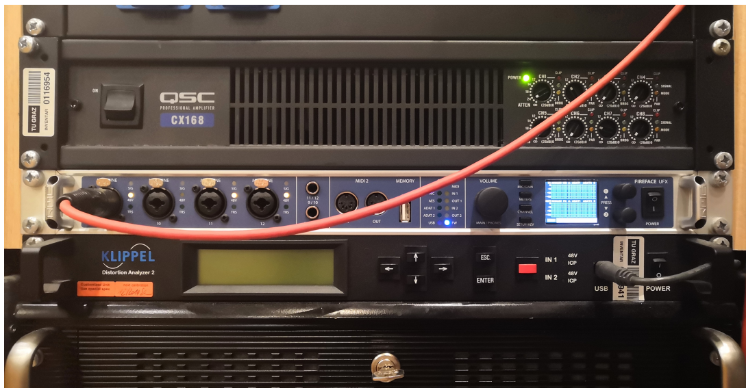
Abbildung 8.1: Messrack (von oben nach unten: Audioverstärker, Audiointerface, Klippel Distortion Analyzer)
