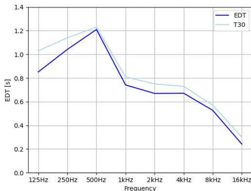
Abb. 3.16: *EDT* und  $T_{30}$  des exakten Raummodells mit Scattering=20%
