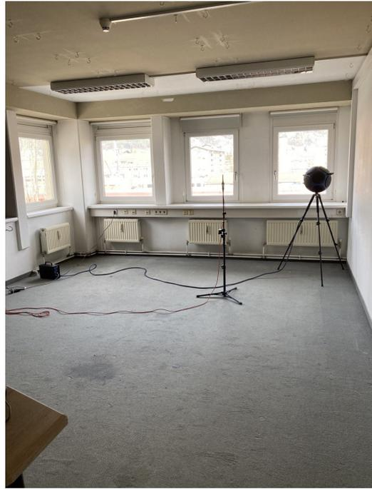
Abb. 2.5: Messaufbau im Raum, Quelle an Position Q2, Mikrophon an Position M1
