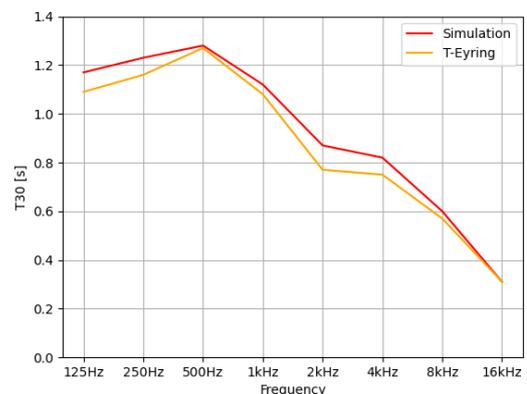
Abb. 3.14:  $T_{30}$  des geglätteten Raummodells mit  $Scattering=20\%$
