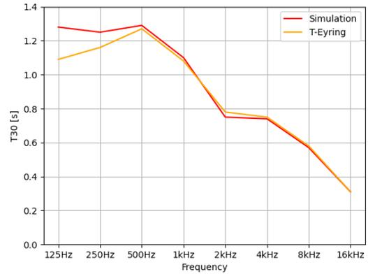
Abb. 3.12:  $T_{30}$  des geglätteten Raummodells mit  $Scattering=100\%$
