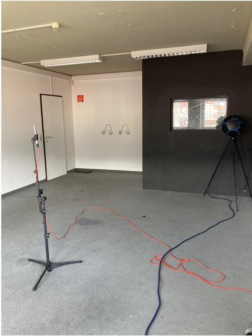
Abb. 2.4: Messaufbau im Raum, Quelle an Position Q1, Mikrophon an Position M3
