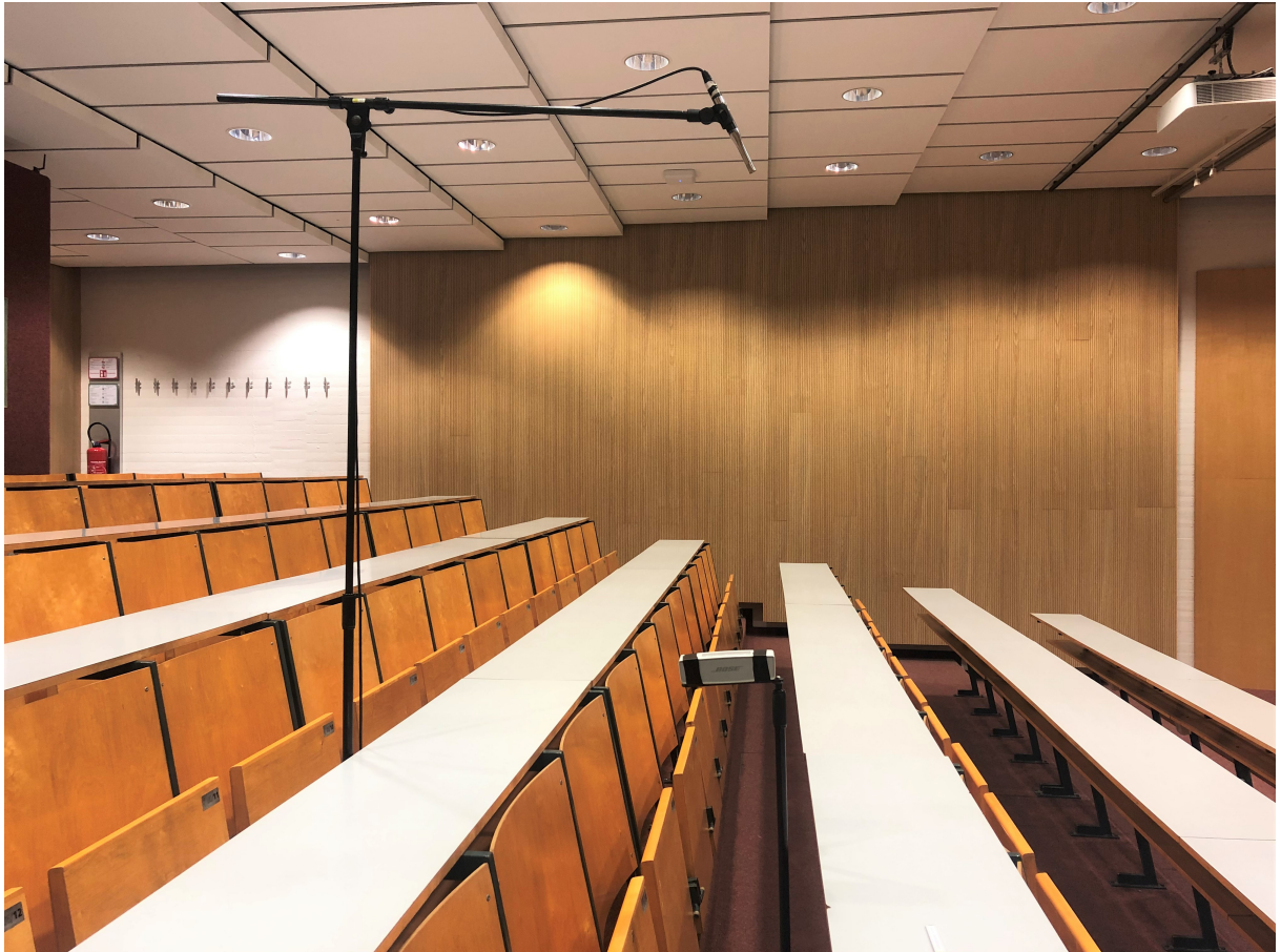
Abbildung 4.4: Aufbau der Testmessung mit Bluetooth-Lautsprecher.
