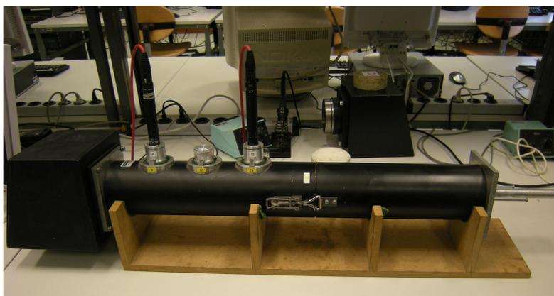
Abb. 2.3.: Das Impedanzrohr der TU Graz am Messplatz
