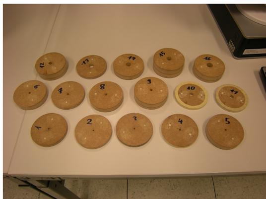
Abb. 3.1.: Aus MDF-Platten gefertigte Frontscheiben
