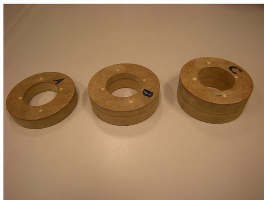
Abb. 3.2.: Ringe aus MDF zur Verkleinerung des Volumens
