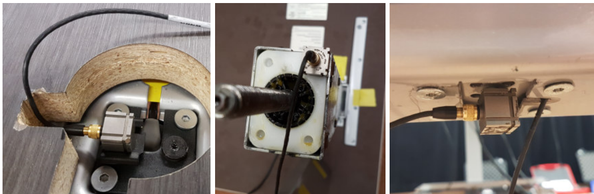
(b) KEP - schwarze Schrauben zwischen Antrieb und Aufnehmerplatte (Antrieb oben) (c) KEP - Verbindung zwischen Mittenadapter und mittlerem Säulenelement über vier Stifte (Mittenadapter) (d) KEP - Schraube zwischen Spindel und unterem Säulenelement (Antrieb unten)
