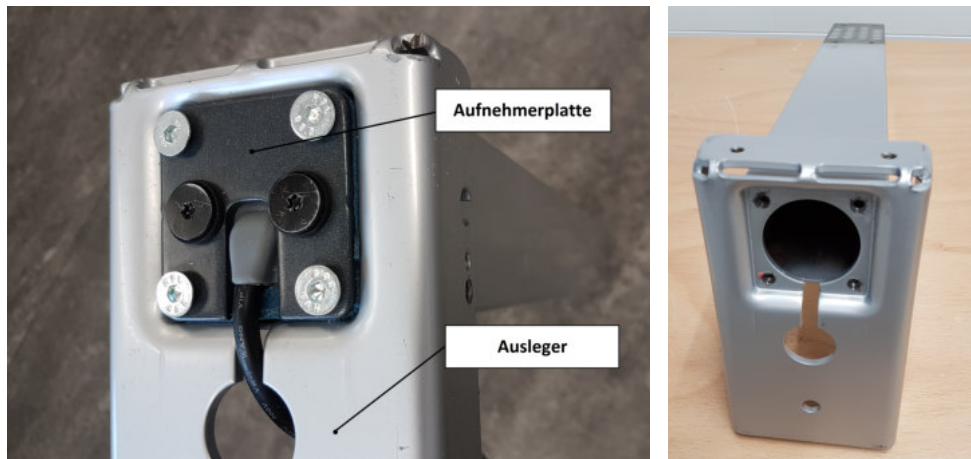
(a) Verschraubung (schwarze Schrauben) zwischen Antrieb und Aufnehmerplatte (b) oberes Säulenelement mit Ausleger
