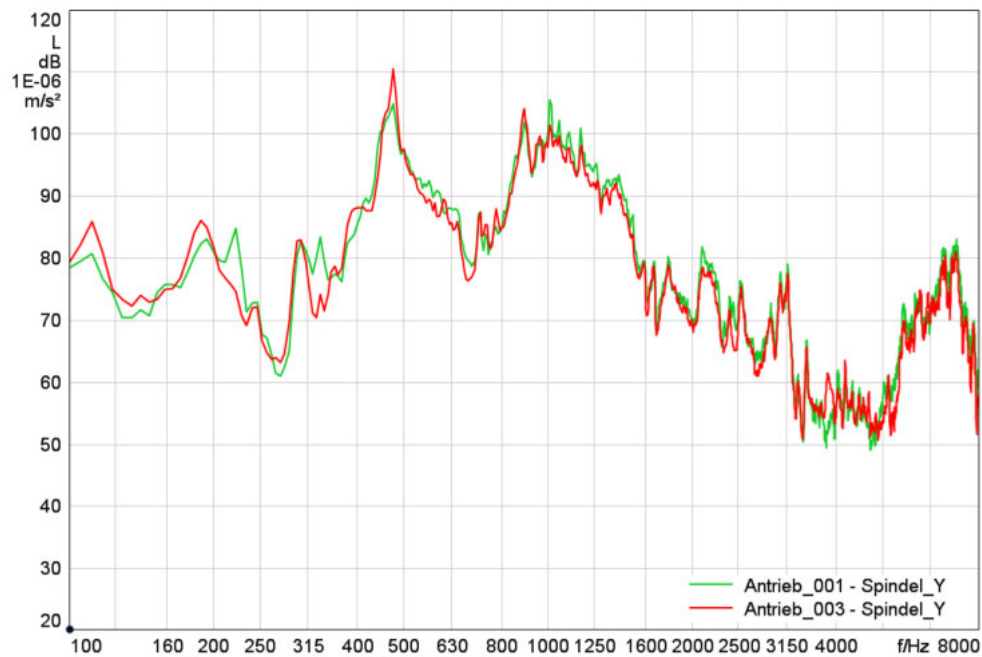
Abbildung 7.3: Darstellung gut zueinander passender Antriebe mit gedämpften Getriebefrequenzen gemessen nahe der Spindel.
