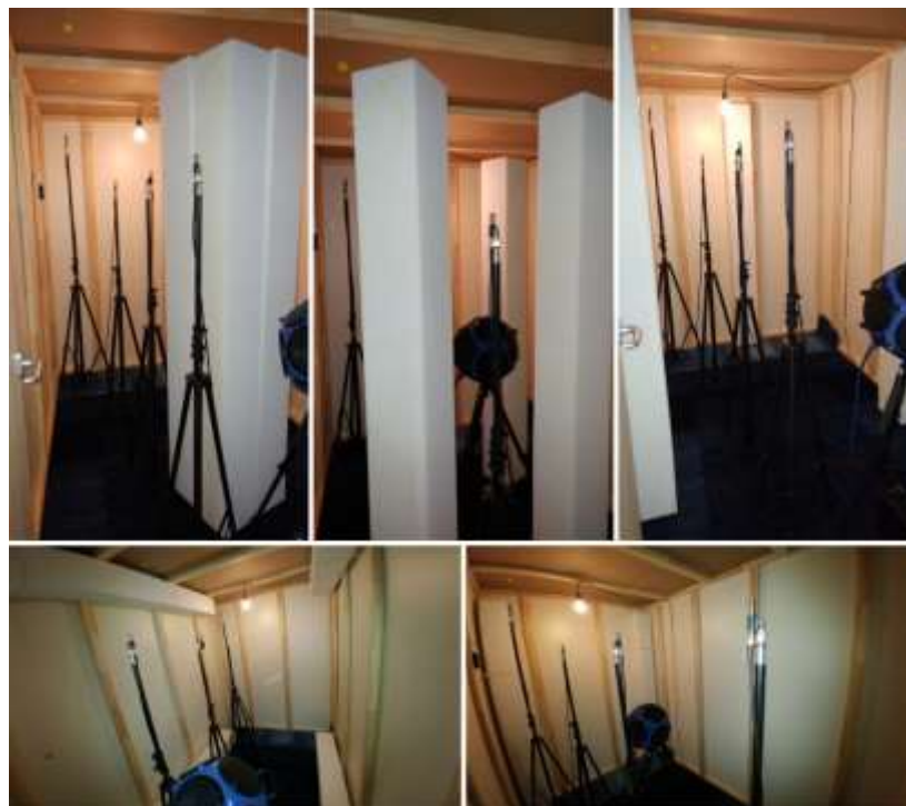
Abb. 6.10: Messsituationen in der Übekabine mit Basotect-Säulen zusammen in der Mitte [oben links], frei verteilt [oben mittig], zentral an Wänden [oben rechts], in horizontalen Kanten [unten links] und in vertikalen Kanten [unten rechts]
