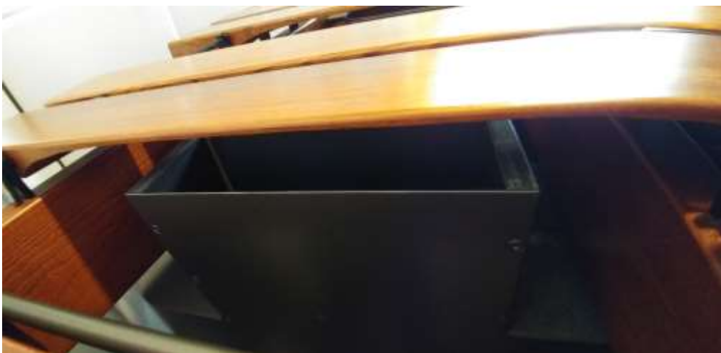
Abb. 2.1: Klangstab mit zugehörigem Helmholtz-Resonator (C#)
