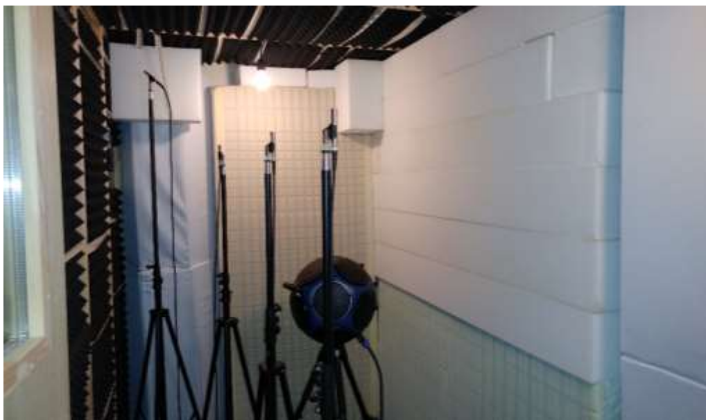
Abb. 6.6: Messsituation in der Übekabine zum Raumausstattungs Zustand (4)
