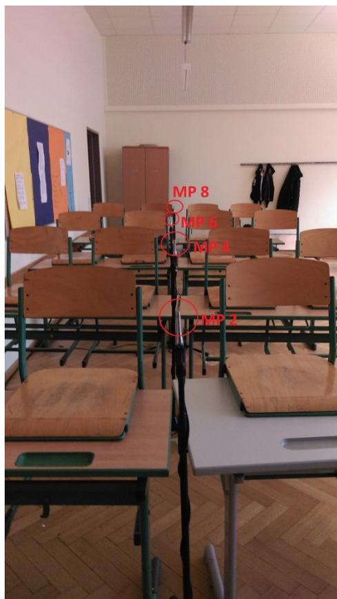
Abb. 17.6: Messaufbau im nicht sanierten Klassenraum, MP 2, 4, 6 und 8
