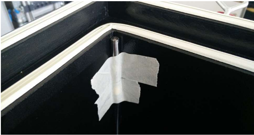
Abbildung 5-31: Provisorische Positionierung des Mikrofons
