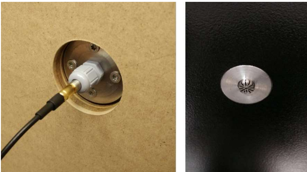
Abbildung 2-4: Fertige Mikrofon-Durchführung an der Kammer
