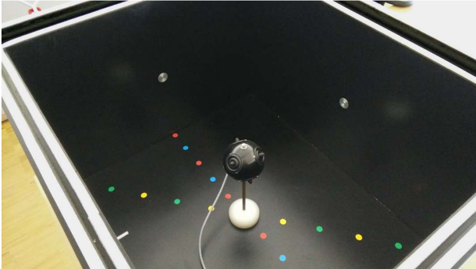
Abbildung 5-40: Aufstellung des Hochtonlautsprechers für die Messung in der Kammer
