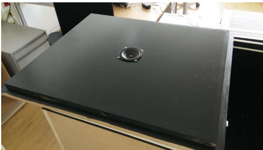
Abbildung 5-8: Der zweite Lautsprecherdeckel für die Messkammer mit zentraler Lautsprecherposition
