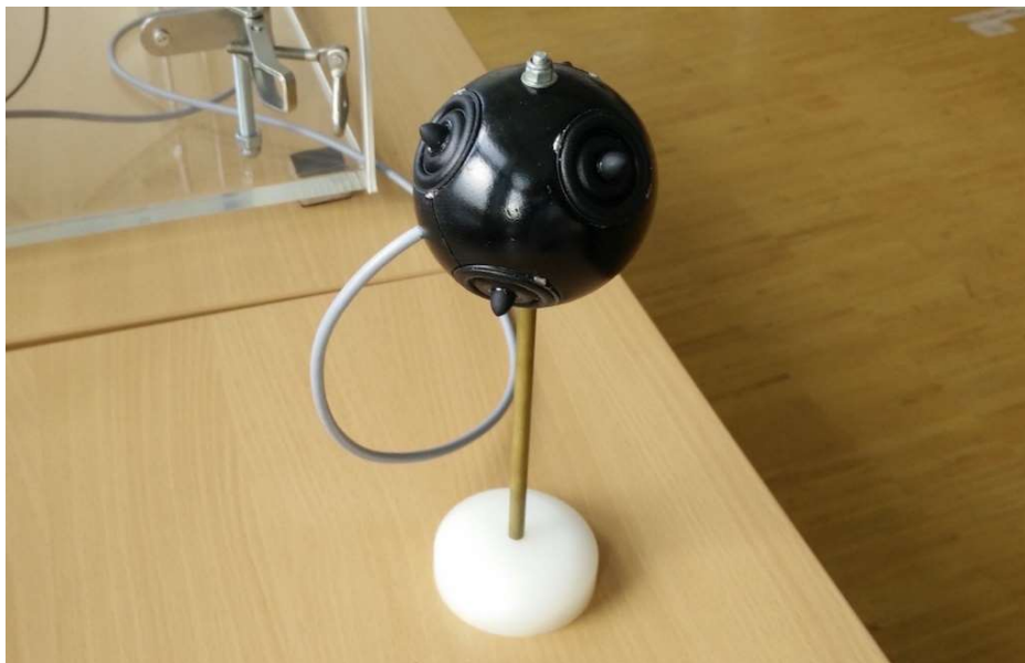
Abbildung 5-39: Hexaeder-Hochtוןlautsprecher für Miniaturhallraummessungen
