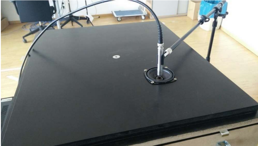
Abbildung 5-7: Ansicht des ersten Deckels mit dem eingebauten Lautsprecher bei der Nahfeldmessung
