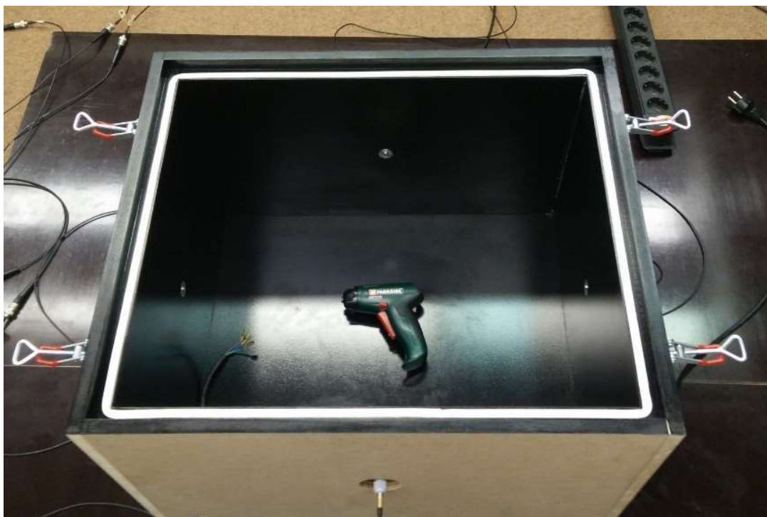
Abbildung 2-6: Abdichtung des Deckels
