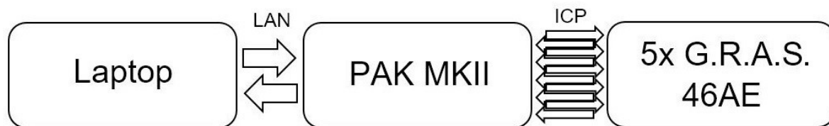
Abbildung 3-4: Schematischer Messaufbau für die Messungen mit dem PAK Mobile MKII und den G.R.A.S. 46AE Mikrofonen
