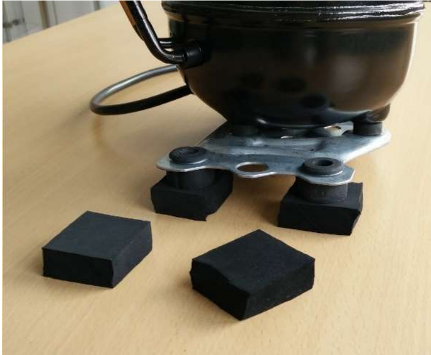
Abbildung 4-9: Zusätzliche Lagerung des Kompressors
