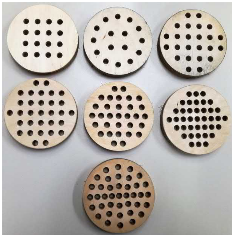
Abbildung 4.2: Vorderseite der untersuchten Lochplatten von links nach rechts: LP10a-LP25b.
