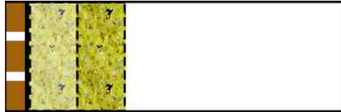
Abbildung 4.25: Schematischer Schichtaufbau zur Messung von Kombinationen aus Absorbermaterial mit unterschiedlicher Strömungsresistenz \Xi . Durch die unterschiedlichen Farbintensitäten der texturierten Bereiche wird hier die Verwendung von zwei unterschiedlichen Absorbermaterialien symbolisiert. Hinter dem Absorbermaterialschichtung wurde ein Luftspalt eingehalten.
