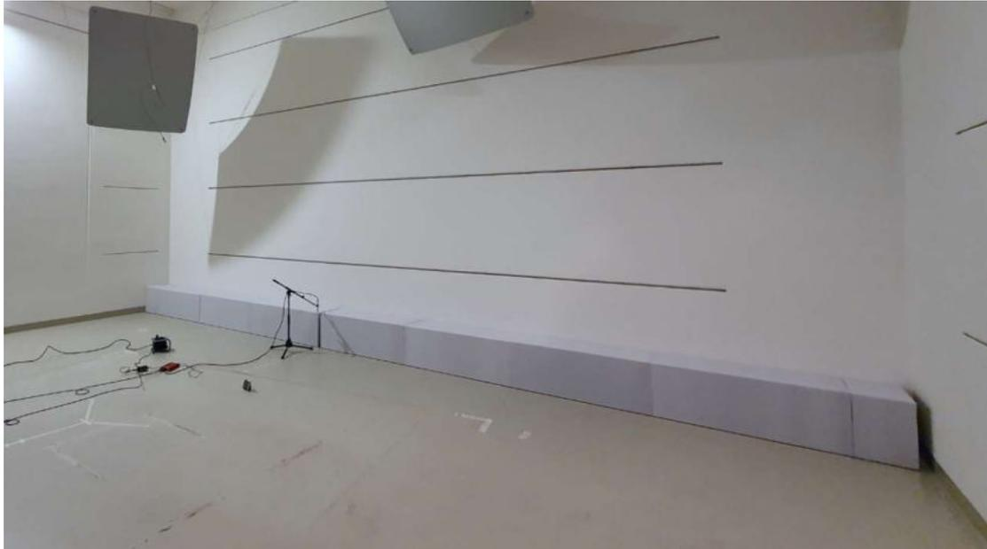
**Abbildung 6.4:** Anordnung der Absorbermodule in der Kante (Konfiguration  $K=1$ )
