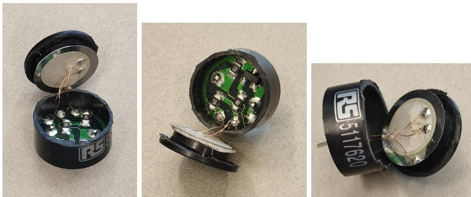
Abbildung 3.46: RS PRO 13.8 geöffnet
