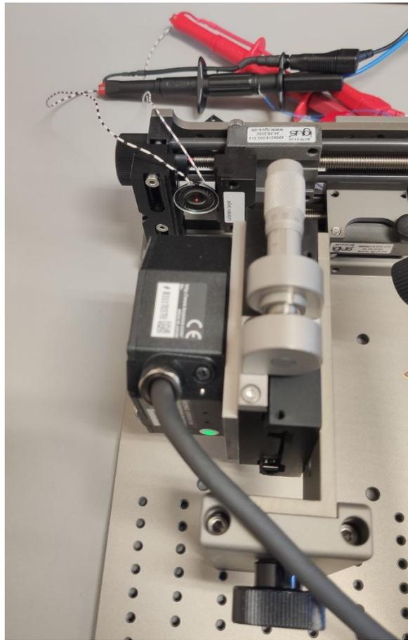
Abbildung 3.3: Messung eines dynamischen Miniaturlautsprechers
