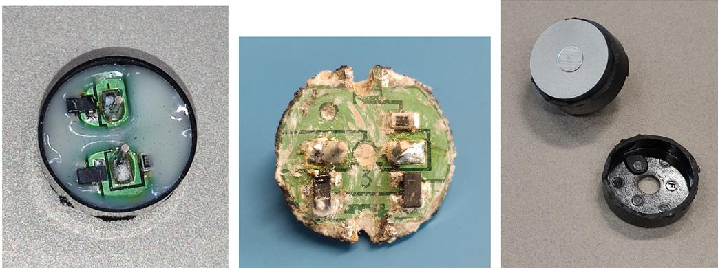
Abbildung 3.30: TDK SDC1610M5 geöffnet
