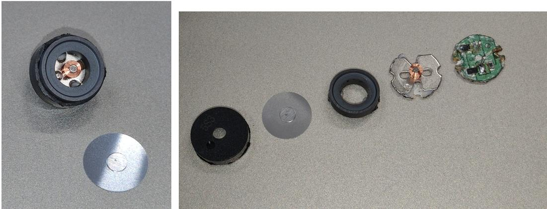
Abbildung 3.31: TDK SDC1610M5 geöffnet
