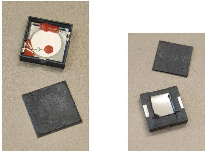
Abbildung 3.38: RS PRO 12x12 geöffnet
