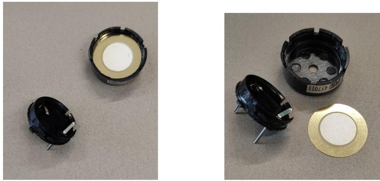
Abbildung 3.42: RS PRO 17 geöffnet
