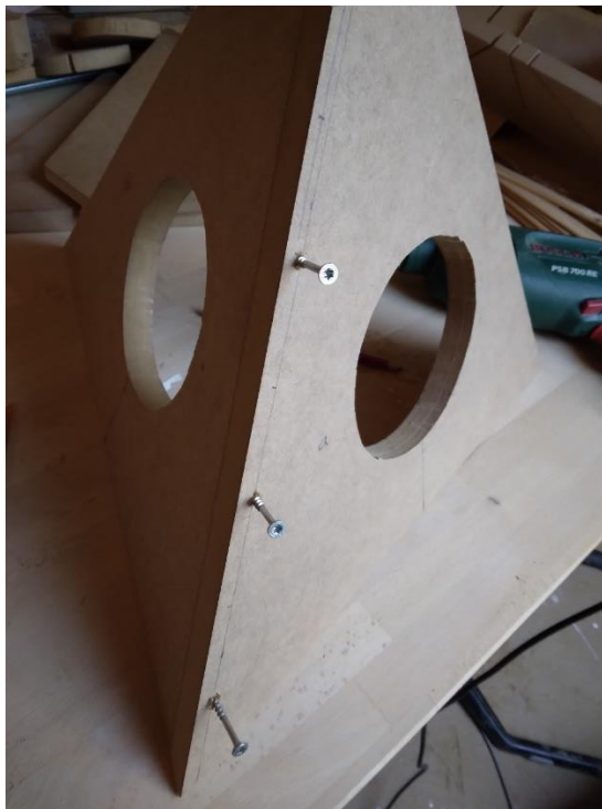
Abbildung 7: Tetraeder – Verleimung und Verschraubung der Seitenplatten
