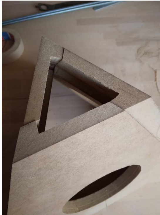
Abbildung 6: Tetraeder – mit vergrößertem Ausschnitt und Lautsprecher-Ausnehmungen
