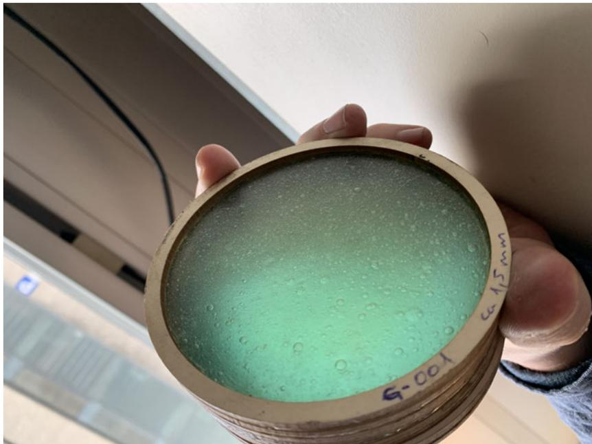
Abbildung 36: Absorberprobe G-001 mit kleinen Lufteinschlüssen.
