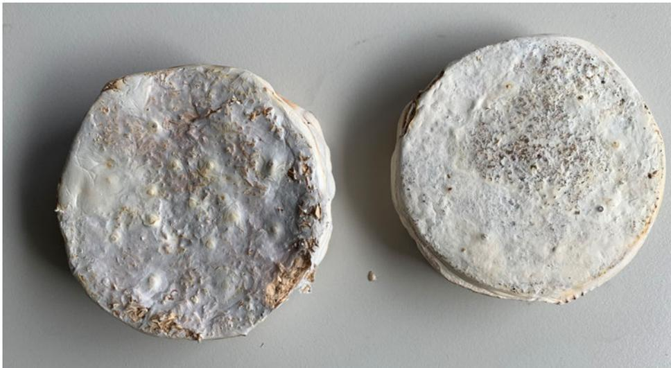
Abbildung 43: Aus Holzspänen und Pilzsporen gewonnene Myceliumproben.
