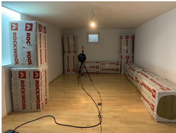
Abbildung 53: Insgesamt 14 Mineralwollepakete sind im Raum verteilt. Dicke: zwischen 55cm und 62cm, hier: Setup 1
