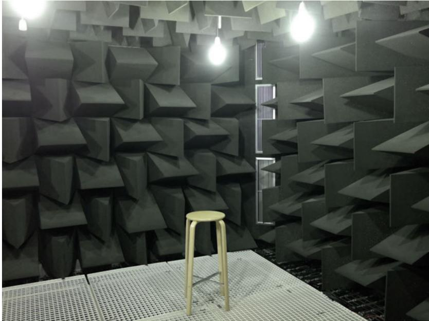
Abbildung 11: Reflexionsarmer Messraum mit horizontal und vertikal angeordneten Keilabsorbern
