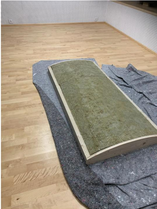
(a) Mineralwolleplatte im Holzrahmen, Drahtgitterabdeckung
