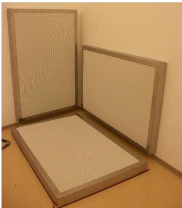
Abbildung 2.1: VPR in den Ecken eines Hallraumes.
