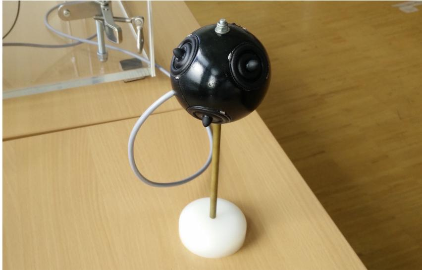
Abbildung 4.11.: Fertiges Lautsprecherensemble
