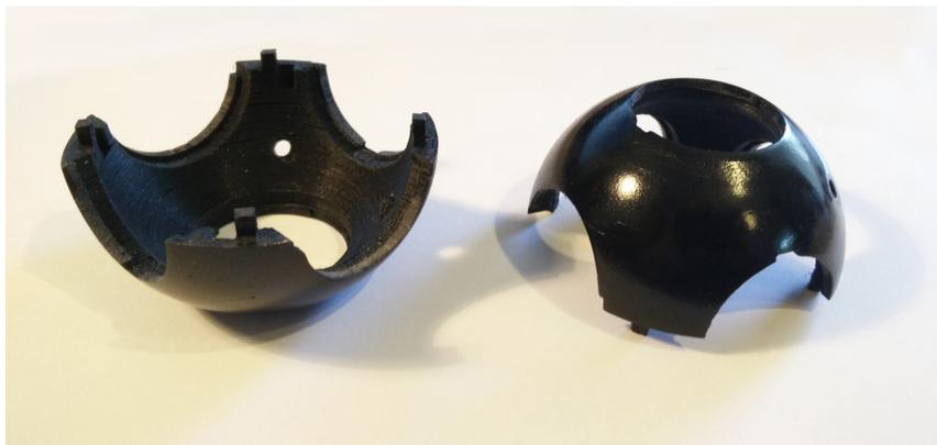
Abbildung 4.10.: 3D-Druck des Lautsprechergehäuses
