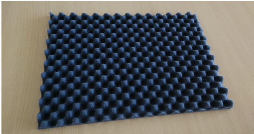
Abbildung 6.1.: Für die Messung verwendete Absorbermatte
