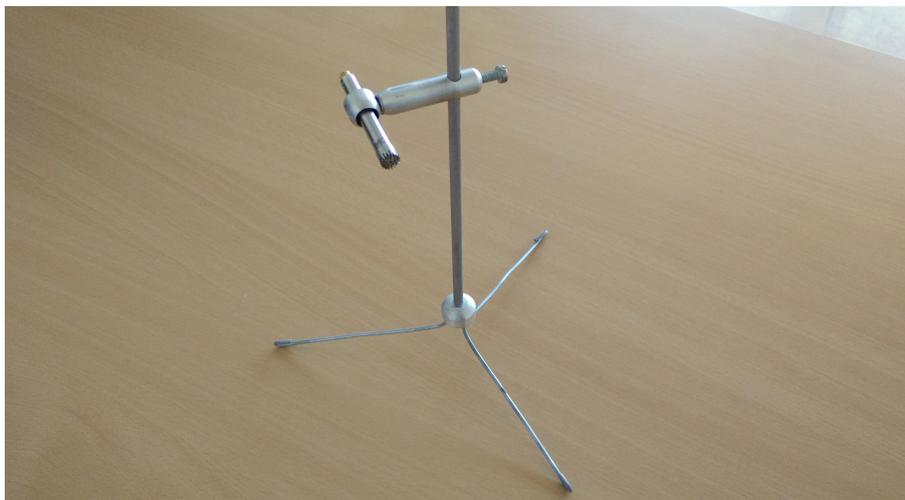
Abbildung 3.8.: Miniaturstativ aus Aluminium mit Drahtfüßen
