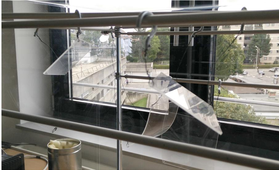
Abbildung 3.7.: An den Alustangen aufgehängte Diffusorplatten
