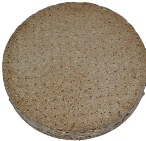
**Abb. 1.4:** Maisplatte in der Draufsicht (Proben-Nr. 8)
