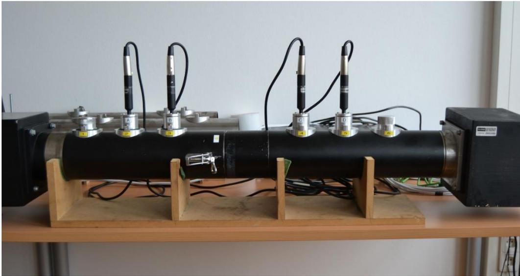
**Abb. 1.8:** Messsystem für die 4-Mikrofonmethode (akustisches Zwei-Tor)
