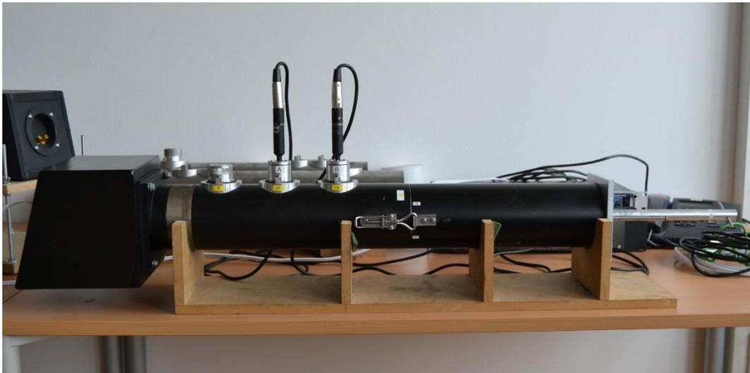
**Abb. 1.7:** Messsystem für die 2-Mikrofonmethode (Ein-Tor-Messung)
