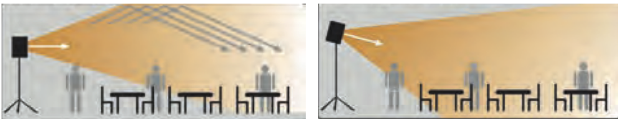
(a) Abstrahlverhalten bei gerader Aufstellung.
