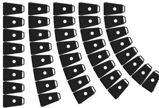
Abbildung 2.13: Curving eines Line-Arrays.
